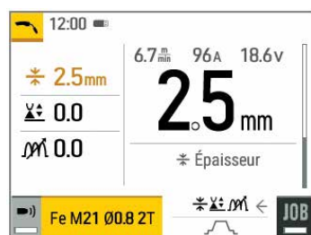
IHM - dévidoir actif
