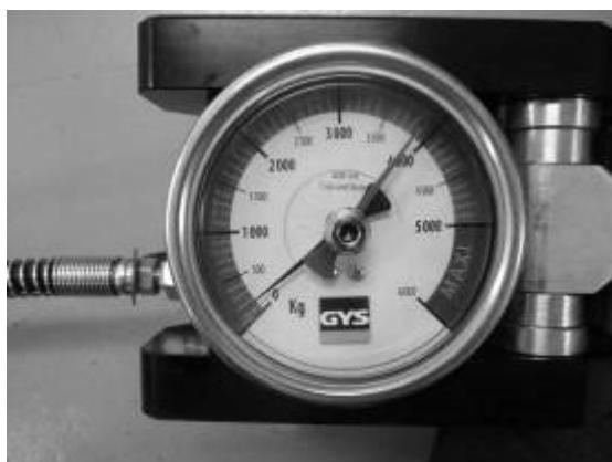
Beim Aufbau des Pumpendruckes zeigt das Manometer die Zugkraft an. Nachdem das Blech gebrochen ist, bleibt die rote Schleppnadel auf dem maximalen Wert stehen (z.B. 3.900 kg für UHSS-Bleche 2,5mm).
