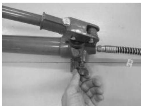
Desserrer la vanne de la pompe, le banc de traction revient à sa position initiale.
