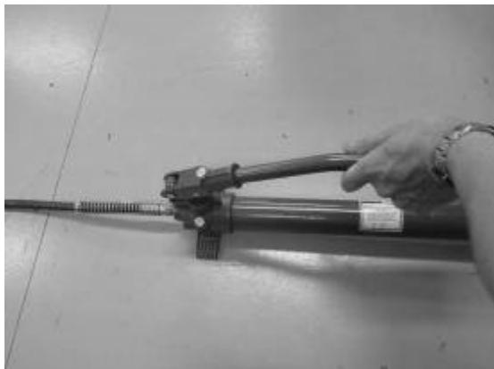
Pomper jusqu'à rupture de la tôle.
