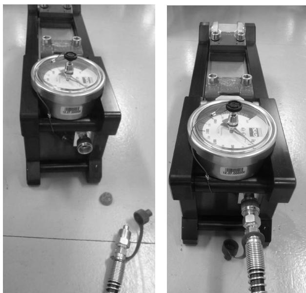
Entfernen Sie die Kunststoffkappe des Pumpenschlauches und verbinden Sie die Verschraubung fest mit der Blech-Zugbank.
