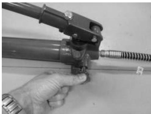
Schließen Sie das Ventil der Pumpe.
