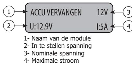
**Vermogensbegrenzing :** Wanneer het symbool « \* » naast de instelling Stroom verschijnt (b.v.« I: 50A\* ») betekent dit dat de lader deze stroom niet zal kunnen leveren bij de via het scherm geregelde spanning. Bij deze spanning zal de lader op z'n maximale vermogen zijn. Deze stroom zal echter wel geleverd kunnen worden voor lagere spanningen, afhankelijk van de vermogenslimiet van de lader.
