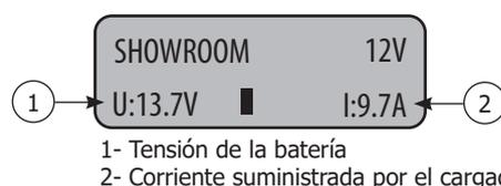
**Precaución:** Al iniciar un modo, si se indica una corriente superior a 10A, esto significará que su batería está descargada. Su Gysflash suministrará una corriente de recarga. Compruebe que no haya dispositivos encendidos en el vehículo. Esperar a que la intensidad pase bajo los 10A antes de iniciar toda acción en el vehículo (uso de los accesorios eléctricos, operación de diagnóstico, etc).
