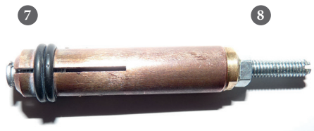
Boquilla en cobre a 4 grietas para soldar las clavijas M4 (diámetro Ø 4 mm)
