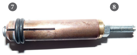
7 Puntale in rame con 4 fessure per saldare perni in alluminio M4 (diametro \varnothing 4 mm)
